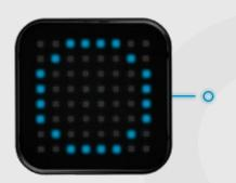
Pour réinitialiser les nœuds aux paramètres d'usine, vous devez appuyer sur le bouton de démarrage du nœud pendant 10 secondes et attendre que le cercle bleu apparaisse.
