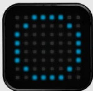
Pour réinitialiser les noeuds aux paramètres d'usine, vous devez appuyer sur le bouton de démarrage du noeud pendant 10 secondes et attendre que le cercle bleu apparaisse.
